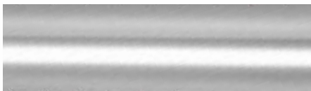
阳极氧化 HV300 Soft anodize HV300 银白色 Silvery white
