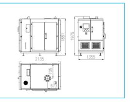
空压机安装于一个相对干净和干燥的室内区域,并留有足够的空间来确保空气流通。请勿将空压机安装于室外或暴露在雨、雪和潮湿的环境中。若不具备上述条件,请在安装前咨询我公司。
